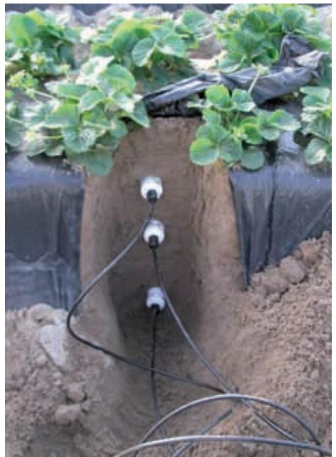
Instalación de sensores de humedad en fresa
